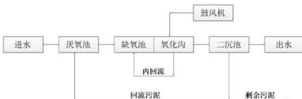
图 4.4-2 A/A/O 工艺流程简图
